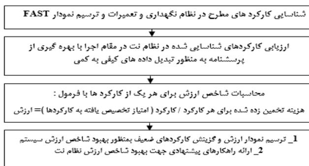
شکل شماره ۲: نحوه به کارگیری مهندسی ارزش در نظام نگهداری و تعمیرات به منظور بهبود اثر بخشی
